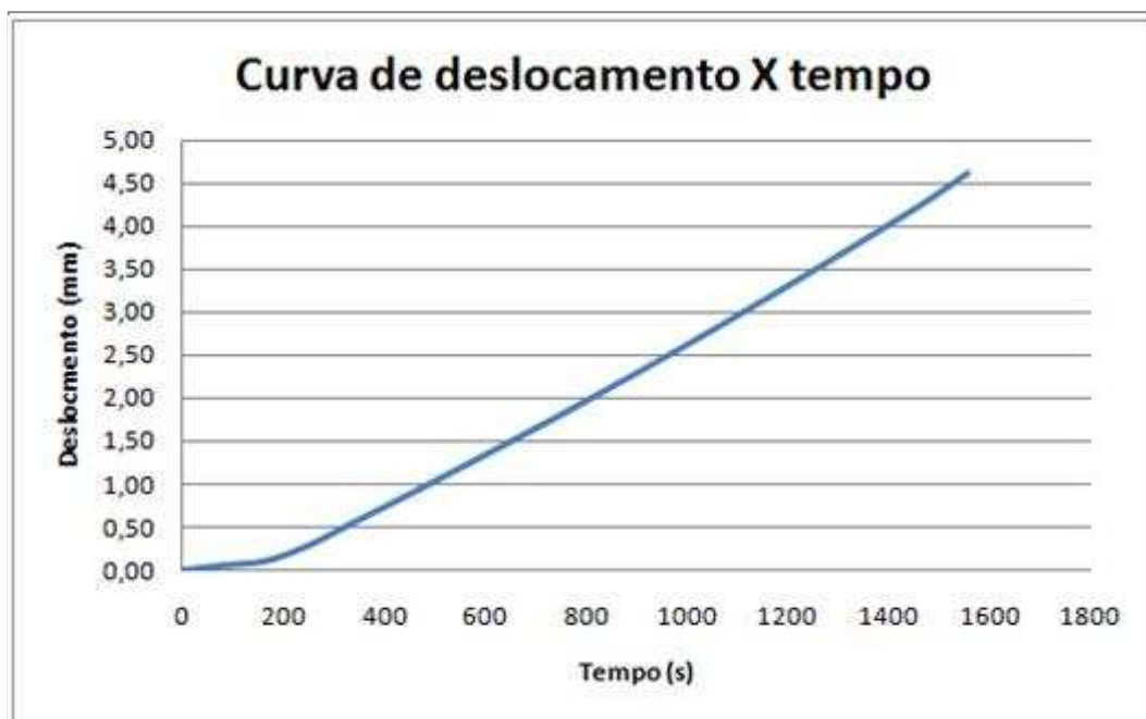
Figura 4.8: Curva de deslocamento imposta à parte superior do corpo de prova.
