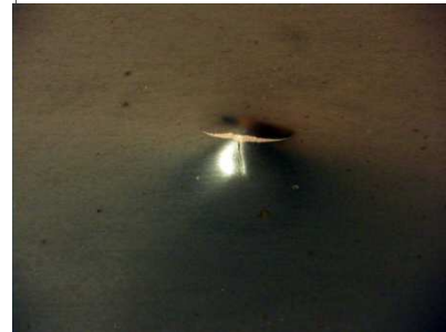
Figura 6.18: Gráfico da velocidade do identador na queda de 2000mm e foto da configuração final da placa para essa queda.
