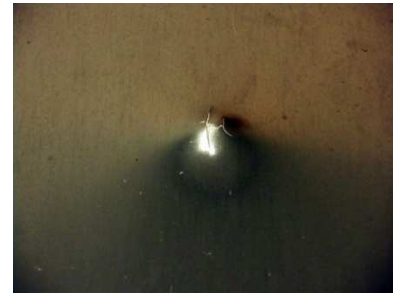
Figura 6.17: Gráfico da velocidade do identador na queda de 1750mm e foto da configuração final da placa para essa queda.
