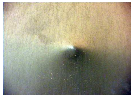
Figura 6.13: Gráfico da velocidade do identador na queda de 750mm e foto da configuração final da placa para essa queda.
