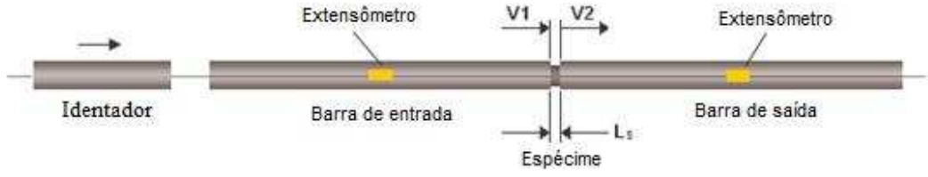
Figura 3.1: Esquema da barra de Hopkinson mostrando componente e variáveis envolvidas.
