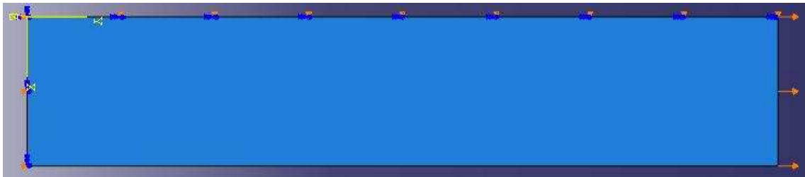
Figura 4.9: Corpo de prova com as condições de movimento impostas.
