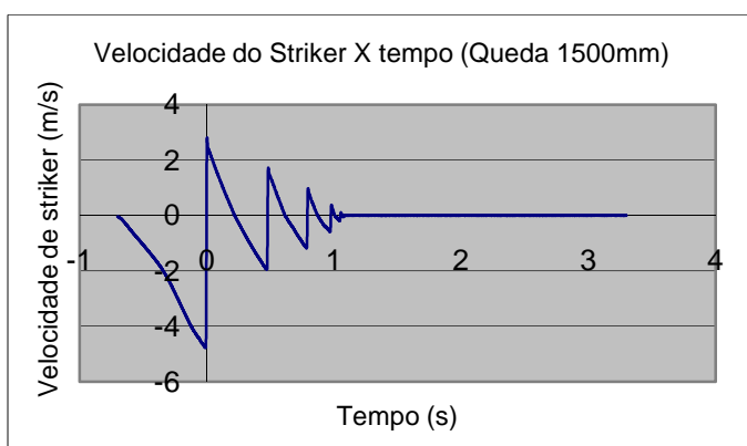
Figura 6.16: Gráfico da velocidade do identador na queda de 1500mm e foto da configuração final da placa para essa queda.
