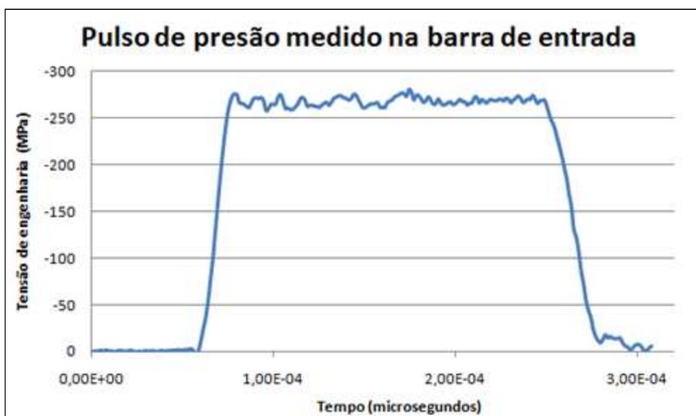
Figura 4.12: Pulso de pressão medido na barra de entrada.
